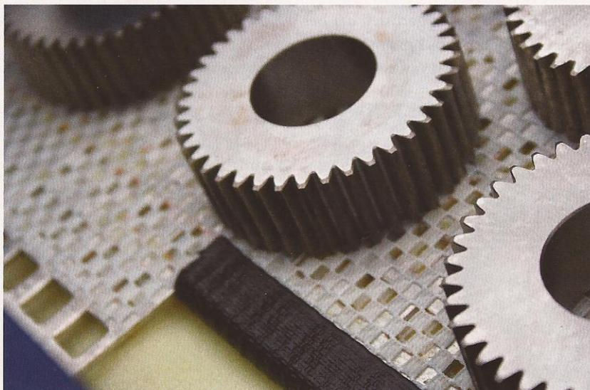
▲ Das Werkstückträgersystem WTS von Almert ist für viele Bauteile verwendbar, da es auf eine mechanische Sperrfunktion verzichtet
